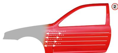
Em seguida, aplicar a primeira demão de base bicamada sobre a área de disfarce, iniciando da peça nova até à orla molhada do Permahyd Blend-in Additive. Imediatamente continuar com a demão de efeito / final, que é aplicada a maior distância do objecto aobre o Permahyd Blend-in Additive molhado e na direcção da peça nova.\*\*\* Um disfarce na diagonal ajuda a realizar a mais indetectável reparação.
