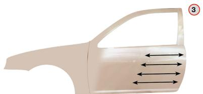
3 Após a superfície evaporar até ficar fosca, aplicar demão leve mas uniforme de Permahyd Blend-in Additive 1050 / 1051 (sem endurecedor) sobre a área de disfarce.
