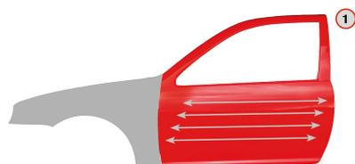
Inicie por aplicar 1 - 2 demãos leves mas uniformes de Permahyd Blend-in Additive 1050 / 1051 sobre a área de disfarce. Assegure que a área de disfarce é suficientemente ampla. Não permitir que o Permahyd Blend-in Additive 1050 / 1051 seque.\*\*
