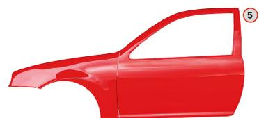
Após o período de evaporação respectivo, aplique o Permsolid Verniz HS sobre a área de reparação completa.
