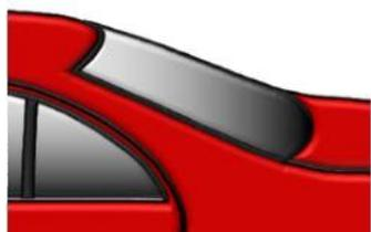
Si nécessaire, poncer légèrement la zone de transition après séchage et refroidissement en fonction du fini à atteindre, par ex. avec 3M Trizact P3000 ou comparable.
