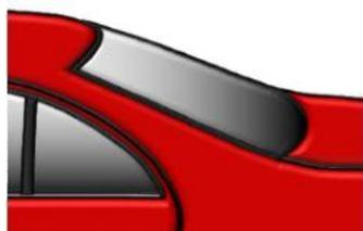
Ponçage de la zone de raccord et de la transition sur l'ancienne peinture intacte, par ex. avec 3M Trizact P3000 Disque de Finition Fin ou abrasifs similaires d'autres fabricants.
