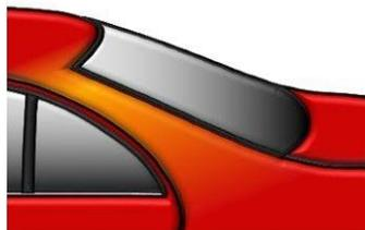
Ponçage de la zone de raccord et de la transition sur la peinture d'origine existante, par ex. avec 3M Trizact P3000 Disque de Finition ou avec des abrasifs similaires d'autres fabricants.
