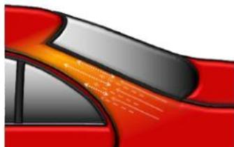
Appliquer pur le Permacron Raccordeur Speed 1036 en plusieurs couches fines à pression réduite sur la zone de raccord. Dissoudre le brouillard de pistelage et adoucir la transition du Permasolid Vernis HS et rester à l'intérieur de la zone poncée au P3000.
