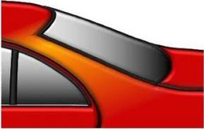
Pulir la zona de difuminado con un compuesto de pulido grueso y eliminar todos los residuos. Lijar la zona de transición hasta la zona dañada con p.ej. P3000 de 3M Trizact o un abrasivo similar. Limpiar la zona preparada con Permahyd Desengrasante 7080.
