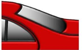
Si es necesario, la zona de transición se puede lijar suavemente después de secar y enfriar, dependiendo del acabado que se quiera conseguir, p.ej. con 3M Trizact P3000 o similar. Pulir con una pulidora rotativa. Controle la presión de contacto y la dirección de la rotación desde la zona donde se ha aplicado el acabado hasta la zona de difuminado.
