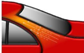
Aplicar Permacron Speed Blender 1036 puro en la zona de difuminado, con manos ligeras y presión reducida. Disolver el exceso de pulverización y realizar una transición suave de Permasolid Monocapa HS 275. Mantenerse dentro de la zona lijada con P3000.
