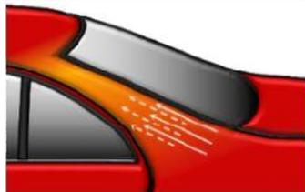
Mezclar Permasolid Monocapa HS 275 según la Ficha Técnica. Aplicar Permasolid Monocapa HS 275 listo para usar para cubrir la zona a reparar y difuminar la zona de difuminado lijada con pasadas solapadas y presión reducida.
