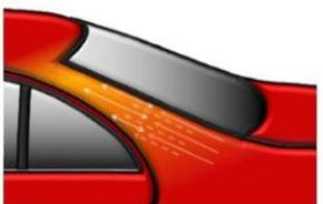
Mezclar Permacron Diluyente para Difuminados 1031 5:1 con Permacron Barniz MS listo para usar y aplicar en la zona de difuminado con manos ligeras y presión reducida. Disolver el exceso de pulverización y realizar una transición suave de Permacron Barniz MS. Mantenerse dentro de la zona de difuminado lijada con P3000.
