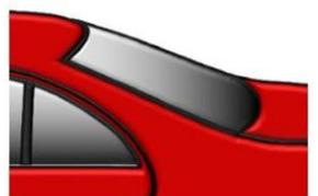
Mezclar Permasolid Monocapa HS 275 según la Ficha Técnica. Aplicar Permasolid Monocapa HS 275 listo para usar para cubrir la zona a reparar y difuminar la zona de difuminado lijada con pasadas solapadas y presión reducida.
