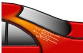
Mezclar Permacron Automotive Top Coat 257/MS Automotive Top Coat 730 según la Ficha Técnica. Aplicar Permacron Automotive Top Coat 257/MS Automotive Top Coat 730 listo para usar para cubrir la zona a reparar y difuminar dentro de la zona lijada con pasadas solapadas y presión reducida.
