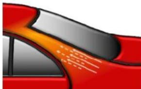
Mezclar el Barniz MS Permacron según la Ficha Técnica. Recubrir Permacron Base Bicap 293/295 con el Barniz MS Permacron listo para usar. Difuminar el barniz dentro de la zona lijada, con pasadas solapadas y presión reducida.
