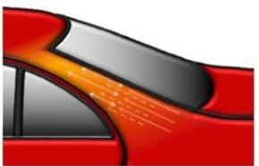
Mezclar Permacron Diluyente para Difuminados 1031 5:1 con Permacron Monocapa 257/MS o Monocapa 730 listos para usar y aplicar en la zona de difuminado con manos ligeras y presión reducida. Disolver el exceso de pulverización y realizar una transición suave de Permacron Monocapa 257/MS o Monocapa 730. Mantenerse dentro de la zona de difuminado lijada con P3000.
