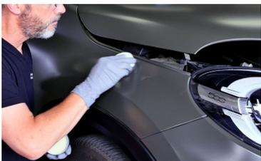
Bitte lassen Sie das Fahrzeug nicht lufttrocknen, um Wasserflecken zu vermeiden. Trocknen Sie das Fahrzeug immer mit einem feuchten Ledertuch oder mit einem weichen Microfasertuch. Waschen Sie das Fahrzeug nicht unter direkter Sonneneinstrahlung und stellen Sie sicher, dass die Lackoberfläche nicht heiß ist.
