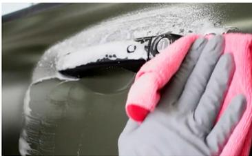
Wenn Sie das Fahrzeug von Hand waschen, verwenden Sie nicht denselben Schwamm für Räder und lackierte Oberflächen, da harte Schmutzpartikel oder kleine Steine in den Schwamm eindringen können und Kratzer auf der Mattlackierung hinterlassen können.
