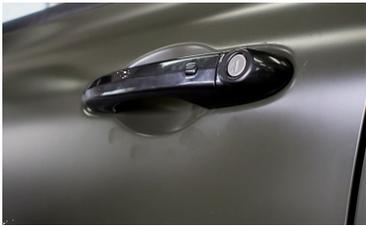
Verwenden Sie auf der Mattlackierung keine Polier- oder Wachsmittel für glänzende Oberflächen, da dies zu Flecken führt. Schützen Sie die Mattlackierung vor Umwelteinflüssen, indem Sie Produkte verwenden, die speziell für Mattlackierungen entwickelt wurden und halten Sie sich immer an die Hinweise des Herstellers.
