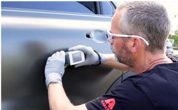
Wenn Sie eine Stelle für die Messung ausgewählt haben, entfernen Sie jegliche Verunreinigung mit Permaloid® Silikon Entferner 7010 und/oder Permahyd® Silikon Entferner 7080.
