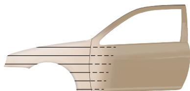
Aplicar Permahyd® Base Coat 280 sobre a área aparelhada, até formar um filme opaco. Utilizar técnica de disfarce com pressão reduzida. Evaporar 5 - 10 minutos. Secar 15 - 20 minutos a 60 - 65°C
