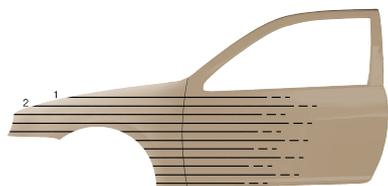
Aplicar Permahyd Pearl Base Coat 285/286 sobre a mesma área, ampliando a aplicação de cada demão subsequente, através de um processo de sobreposição assegurando que iguala o acabamento original. Pulverize com ar, após cada demão.
