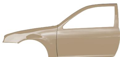
Após o período de evaporação respectivo, aplique o Permsolid Verniz HS sobre a área de reparação completa.
