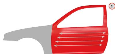
Iniziare con l'applicazione di 1 - 2 mani chiuse di Permahyd Blend-in Additive 1050/1051\* sulla zona di sfumatura. Assicurarsi che l'area di sfumatura sia sufficientemente ampia. Non lasciare asciugare Permahyd Blend-in Additive 1050 / 1051.\*\*
