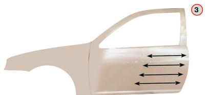
3 Dopo l'appassimento fino ad opacizzazione, applicare una mano chiusa di Permahyd Blend-in Additive 1050/1051 puro (senza catalizzatore) sulla zona di sfumatura.
