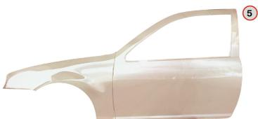
5 Dopo l'appassimento, applicare sull'intera zona di riparazione il trasparente Permasolid HS.
