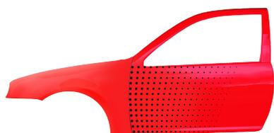
Eeguire la sfumatura del colore nell'area adiacente alla riparazione, con pressione ridotta.
