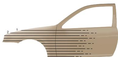
Applicare Permacron Basislack 295 sulla stessa area, estendendo l'area di applicazione ad ogni mano in modo da assicurare la riproduzione della finitura originale e un ritocco invisibile.
