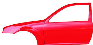
Dopo l'appassimento, applicare sull'intera zona di riparazione il trasparente Permasolid HS.
