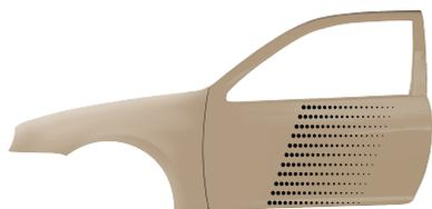
Diluire Permacron Pearl Base Coat 295 pronto all'uso 1:1 con Supercryl Reducer 3054 e sfumare nella zona di transizione.
