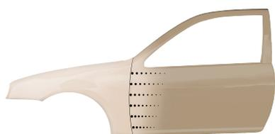
Diluire Permacron Base Coat 293 pronto all'uso 1:1 con Supercryl Reducer 3054 ed applicare con una leggera sfumatura.
