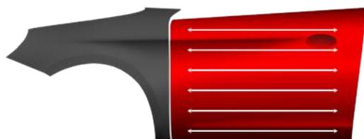
Panel de reparación: lijar el aparejo (mínimo P500). Panel adyacente: preparar para el difuminado utilizando un abrasivo adecuado, p.ej. Trizact – P1000.
