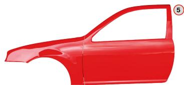
Nach dem Ablüften wird über die gesamte Reparaturfläche ein Permasolid HS Klarlack aufgetragen.
