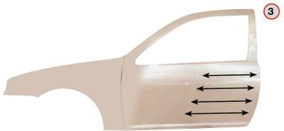
Nachdem die Oberfläche matt abgelüftet ist, einen geschlossenen Spritzgang Permahyd Beispritz Additiv 1050 / 1051 pur (ohne Härter) auf den Beilackierbereich applizieren.
