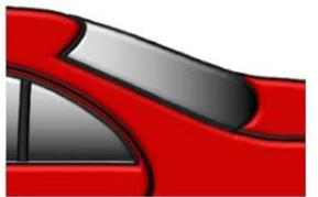
Wenn nötig und in Abhängigkeit vom gewünschten Endergebnis, kann die Übergangszone nach der Trocknung und Abkühlung leicht mit 3M Trizact P3000 oder ähnlichen Schleifmitteln geschliffen werden. Polieren mit einer rotierenden Poliermaschine. Polierdruck kontrollieren und Rotation immer in Richtung der Altlackierung betreiben. Nicht gegen die Beilackierkante polieren.
