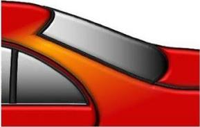
Den Auslaufbereich mit einem groben Poliermittel polieren und alle Rückstände abwischen. Den Übergang zur Schadenstelle z.B. mit 3M Trizact P3000 oder ähnlichen Schleifmitteln anderer Hersteller schleifen. Den vorbereiteten Bereich mit Permahyd Silikon Entferner 7080 reinigen.
