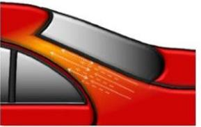
Den puren Permacron Race Blender 1070 in dünnen Spritzgängen in den polierten Beilackierbereich applizieren (mit reduziertem Spritzdruck, wenn eine Spritzpistole verwendet wird). Den Spritznebel auflösen und einen weichen Übergang herstellen. Trocknung gemäß Technischem Datenblatt des jeweiligen Klarlacks. Eine zusätzliche IR-Nachtrocknung der Beilackierzone kann das Risiko des Kantenabrisses beim Polieren reduzieren.
